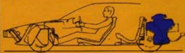
Quergestellter Motor im Heck, laute Lösung
