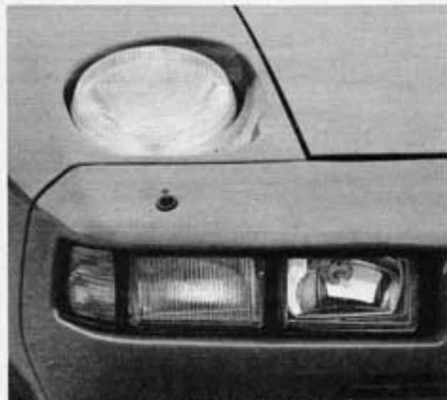
Nebelscheinwerfer und Fernlicht in der Stoßstange
