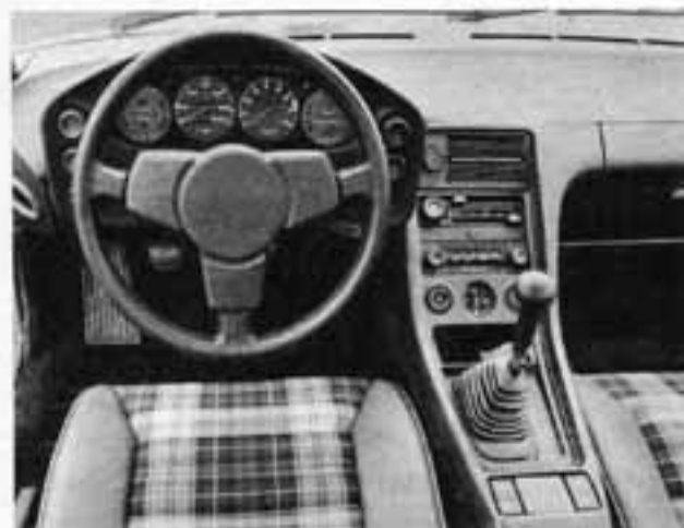
Armaturenbrett und Lenkrad sind schwenkbar
