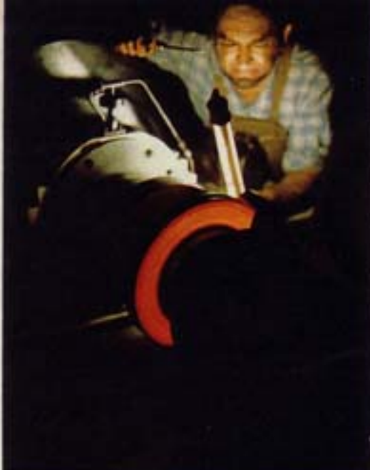
Bremstest: Volle Wirkung bei glühender Scheibe
