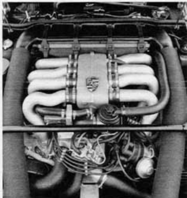
Aluminium-Motor mit acht Zylindern und 240 PS
